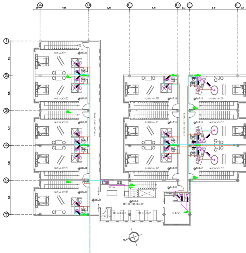
Ilustración 23 Instalaciones hidrosanitarias segunda planta.
