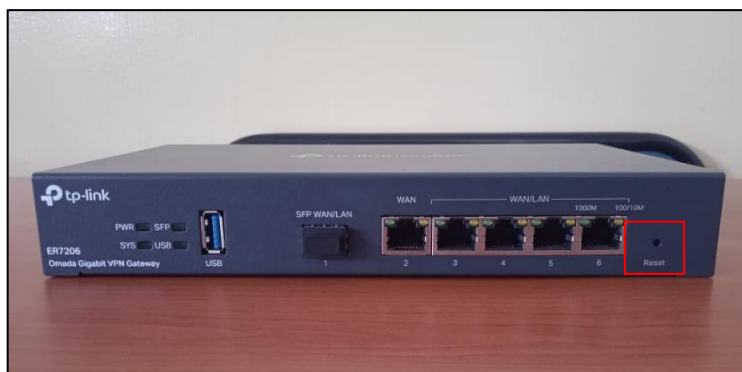
Figura 47. Restauración física mediante botón frontal.
