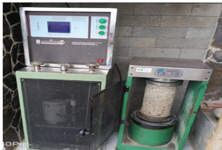
Prensa de hormigón para ensayo de compresión simple
