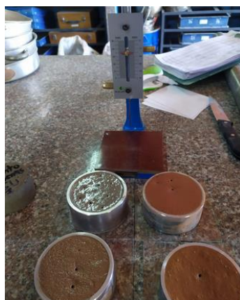
Figura 9: Ensayo de Aguja de Vicat
