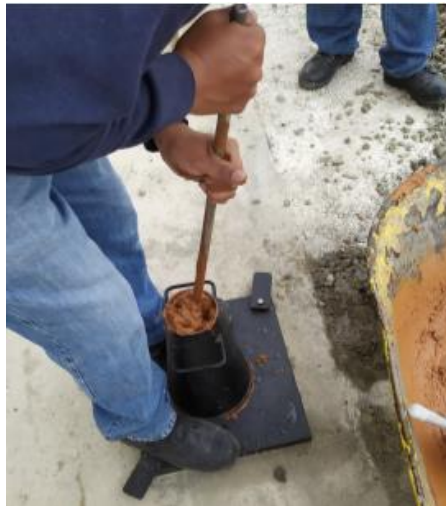
Figura 7: Asentamiento del cono de Abrams.
