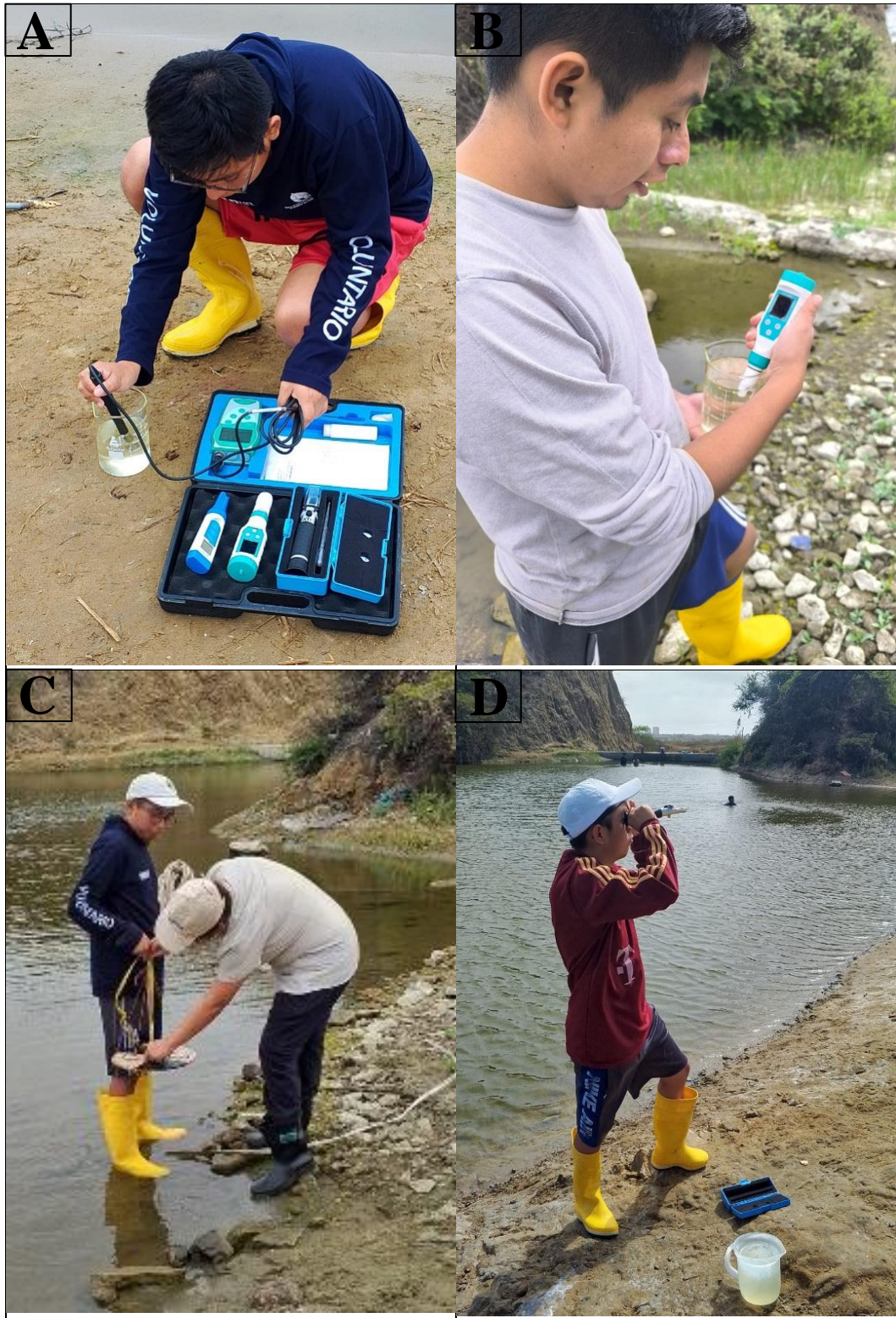
Anexo 18. Uso de instrumentos para medición de parámetros fisicoquímicos. A: Medidor de oxígeno, B: pH-metro, C: Disco Secchi, D: Salino-metro
