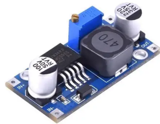
Figura 29: Modulo LM2596. Fuente: [53]
