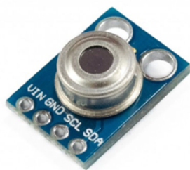
Figura 25: Sensor infrarrojo MLX90614. Fuente: [49]
