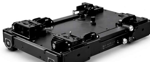
Ilustración 17: Chasis del ROSMaster X3.
