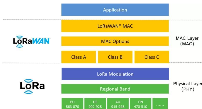
Figura 8. Capas de protocolo LoRa (Venco, 2022)
