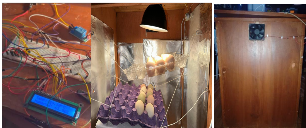
Figura 11. Disposición de componentes electrónicos que integran el sistema Arduino en el prototipo de incubadora artesanal.
