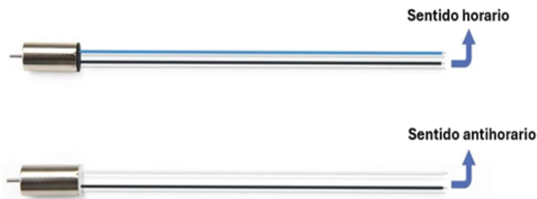
Figura 62: Motores sin escobillas del dron Tello DJI. [Autoría propia]
