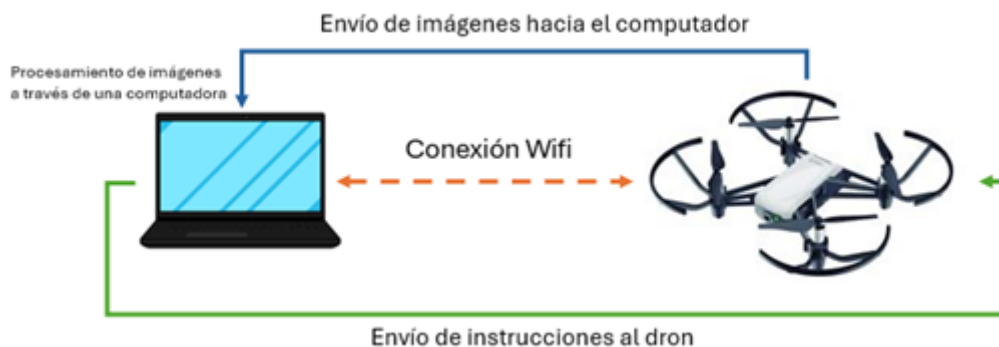
Figura 70: Interconexiones del dron y el dispositivo de computo. [Autoría propia]
