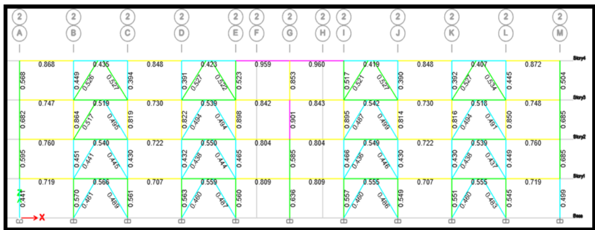
Figura 31 Elevación del pórtico crítico con arriostramiento excéntrico.
