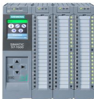
Figura 15. PLC SIMATIC S7-1500 1512C-1 PN. Fuente: [16]
