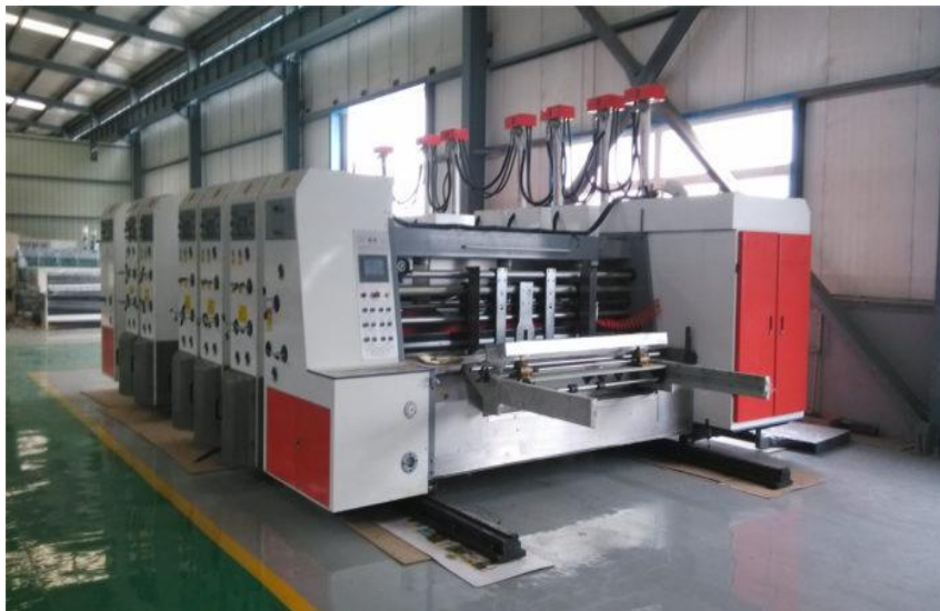
Figura 11. Máquina eslotado (slotter). Fuente: [13]
