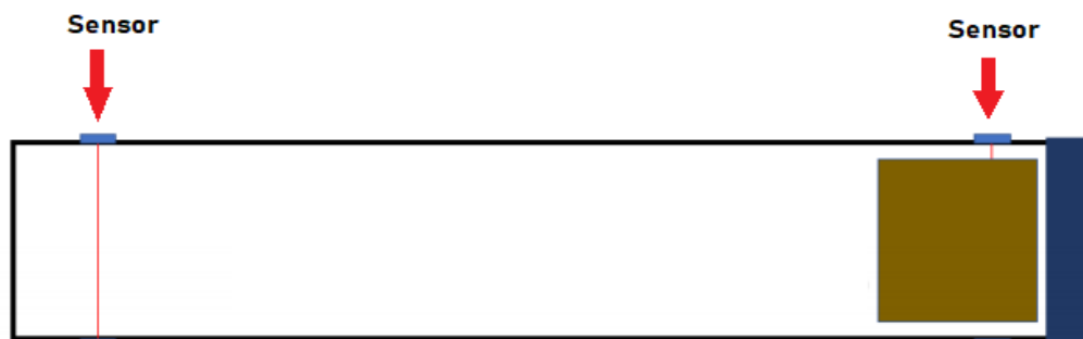
Figura 7. Ubicación de los sensores en rodillos transportadores. Fuente: [12]
