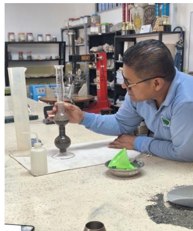
(a) Preparación del material, (b) Arena en el frasco de Chapman.
