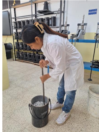
(a) Colocación de agregado grueso, (b) Varillado del material
