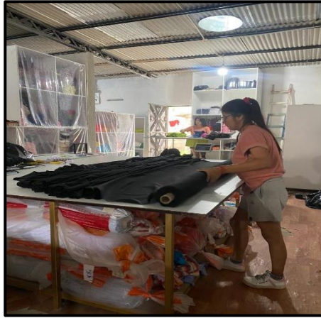
Proceso de tendido y medición
