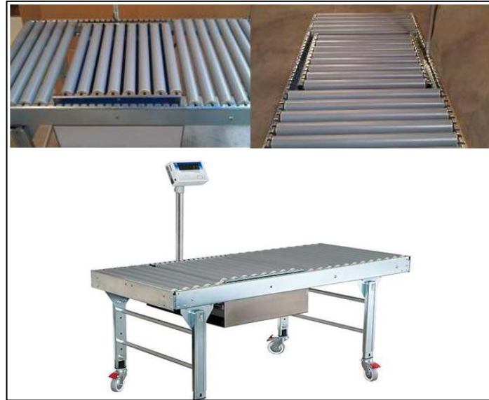
Figura 43. Transportador de rodillos con balanza digital integrada
