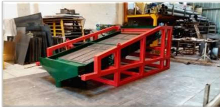
Figura 3: Zaranda Vibratoria; Fuente ( FELCO EUROPA S/L ; 2020)
