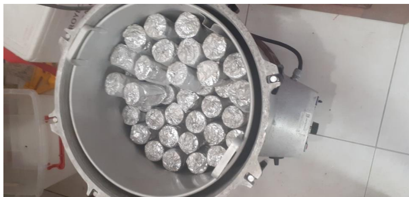
Figura 13: Autoclavado de los frascos para muestras en las instalaciones de UPSE, en CIPBA
