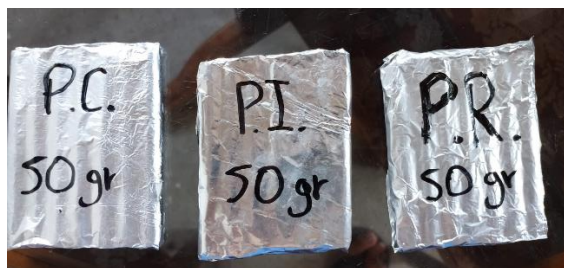
Figura 23. Peso inicial de tizas en cada punto para calcular el índice de disolución de tiza.
