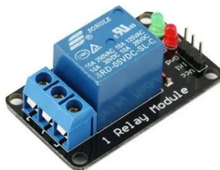
Figura 18 Módulo Relé de 1 canal [30]
