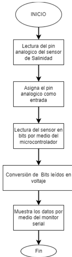
Figura 32 Diagrama de flujo para la lectura del sensor de salinidad Fuente: Autor, 2023.
