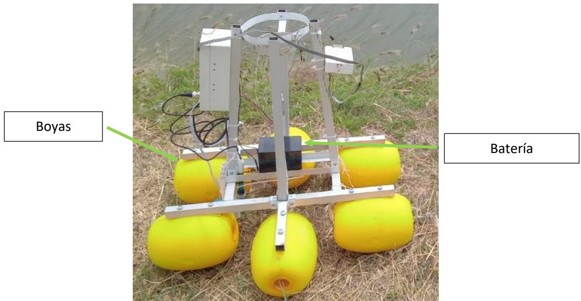
Figura 48 Armado de la estructura del prototipo. Fuente: Autor, 2023.
