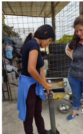
Compactación del material
