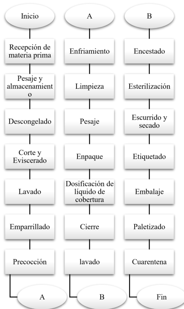
Esquema 18: Diagrama de flujo del proceso de elaboración de conservas de atún
