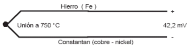
Figura 4. Esquema físico de termocupla tipo J [11].
