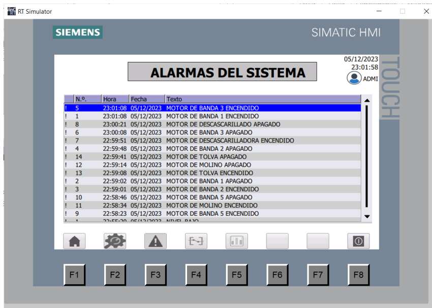
Figura 28. Alarmas del sistema
