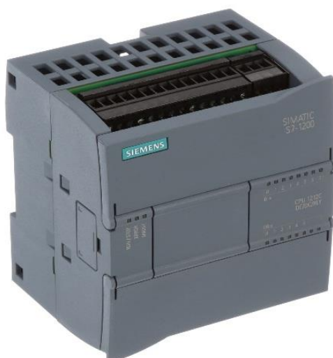
Figura 3: PLC Compacto Siemens S7-1200 Fuente:[20].
