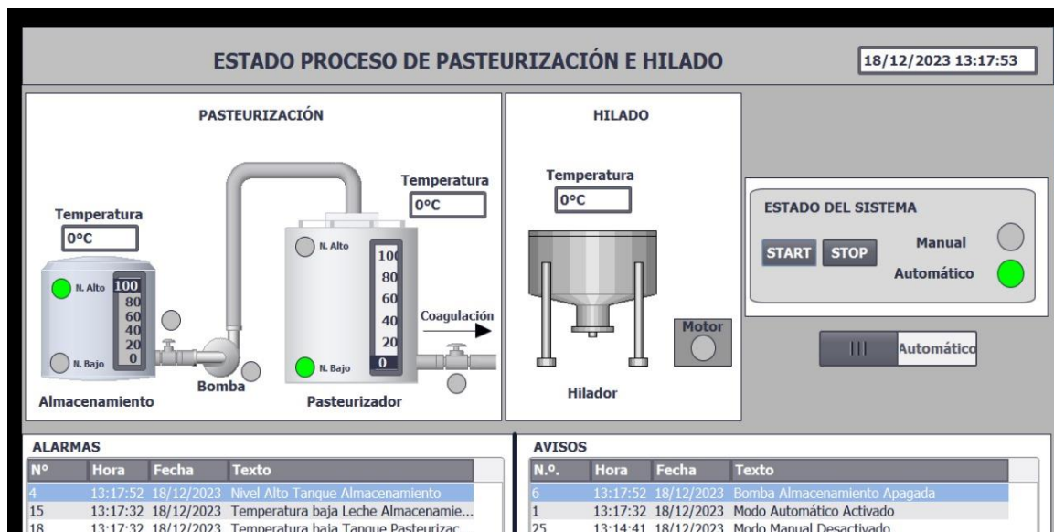
Figura 13: Detección de Nivel Alto por Sensor de Nivel.
