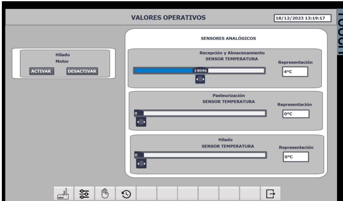
Figura 14: Sensor de Temperatura en un Rango de 4°C.
