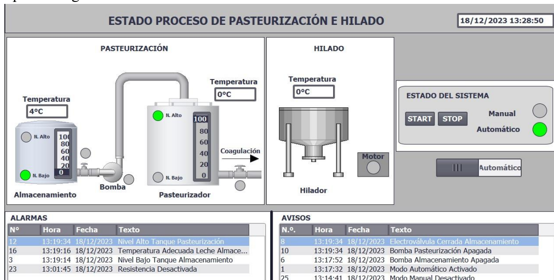
Figura 17: Detección de nivel alto del tanque. Fuente: Autor.
