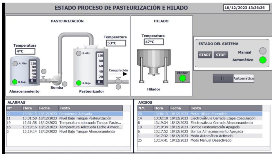
Figura 21: Visualización de los estados de los sensores y actuadores.
