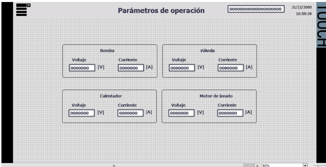
Ilustración 14 Pantalla de parámetros de operación
