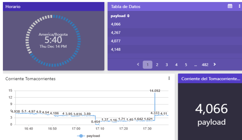
Figura 39. Dashboard de TagoIO para la corriente del tomacorriente
