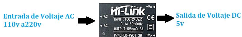
Figura 13. Identificación de pines del HLK-PM01.
