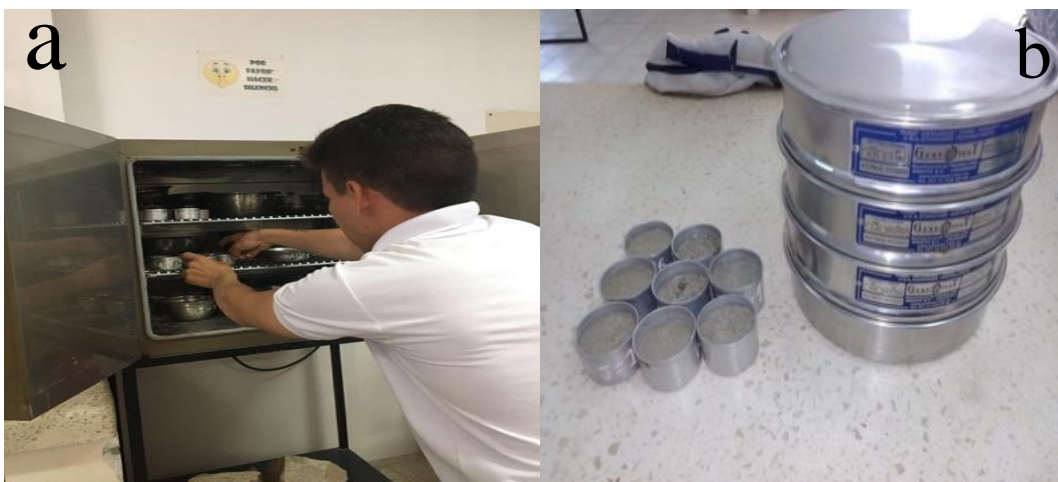
Anexo 2. 4 Análisis de granulometría, colocación de muestras de sedimento en horno (a), juego de tamiz #4, 10, 40 y 200 (b)
