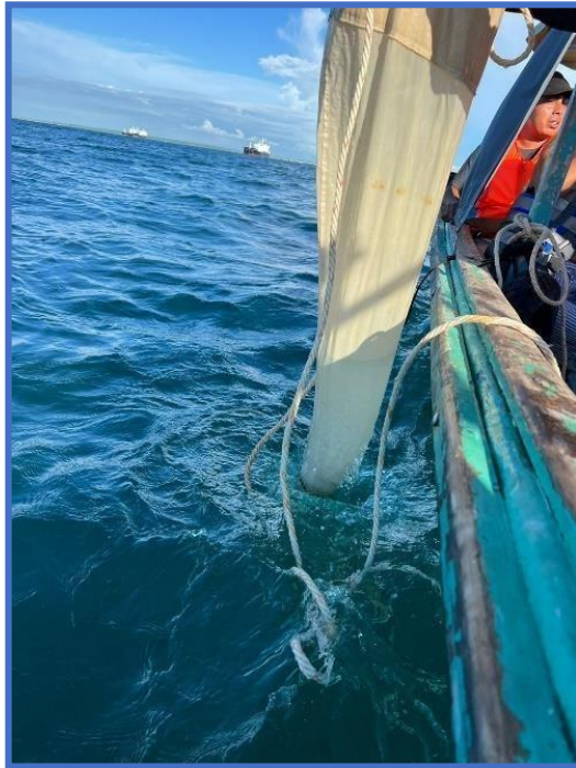
Figura 48. Red cónica simple 55um. utilizada en la recolección de muestras.
