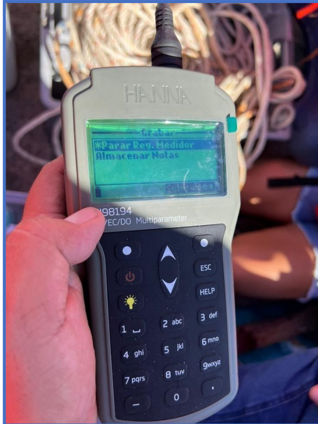
Figura 52. "Multiparámetro: instrumento de medición que evalúa simultáneamente múltiples parámetros en un sistema o entorno específico, proporcionando una visión integral de las condiciones o características analizadas.".
