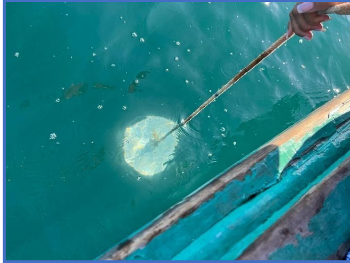
Figura 53. "Disco Secchi, utilizado para evaluar la transparencia del agua en entornos acuáticos."
