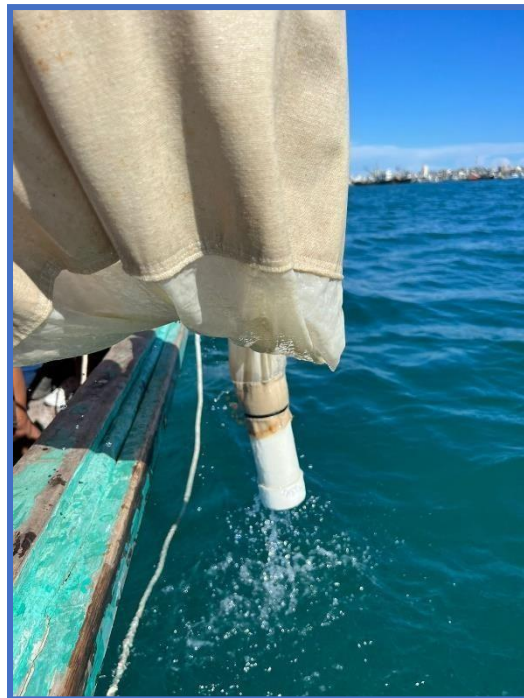
Figura 51. Cubilete de la red cónica, utilizada en los muestreos para la colecta de las especies a analizar.
