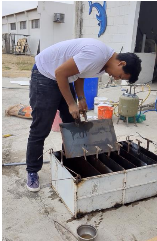
Aplicación de desmoldante al encofrado
