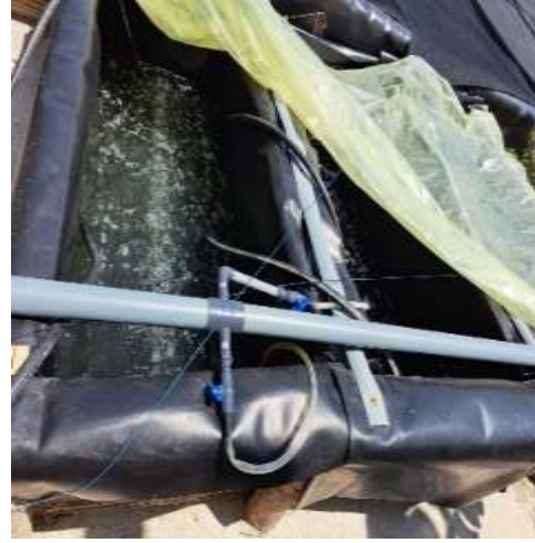
Anexo 23 Líneas de aireación de tanques de cultivo
