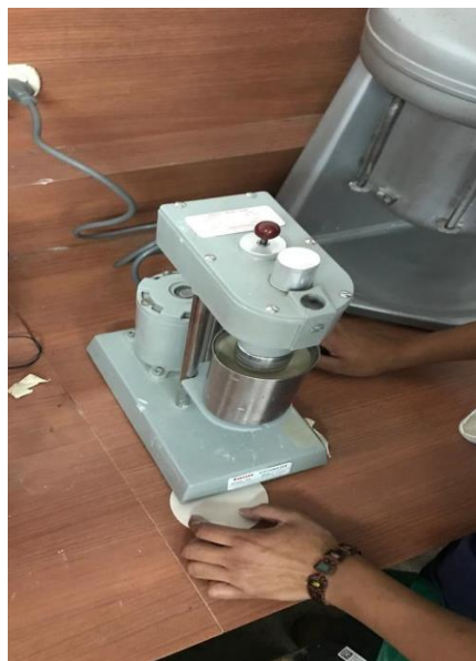
Figura 21. Prueba del viscosímetro de Fann- Fuente: Elaboración propia
