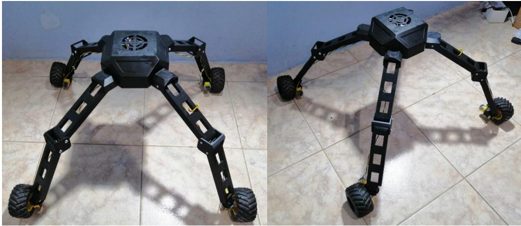
Figura 67. Ensamble de las piezas impresas en 3D.
