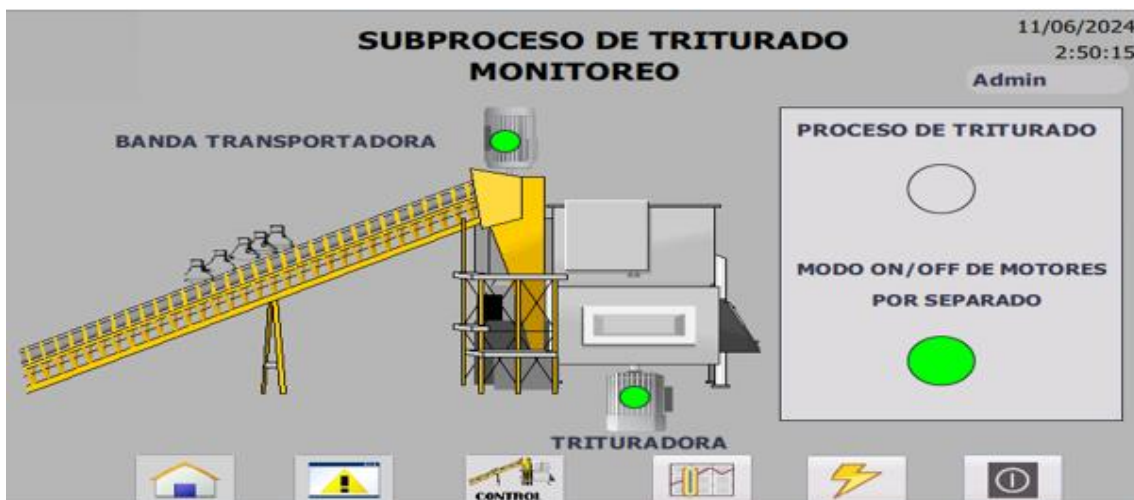
Ilustración 16 Puesto en marcha los motores por separados.
