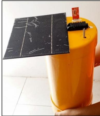
*Figura 43. Colocación del panel solar en cada nodo*
