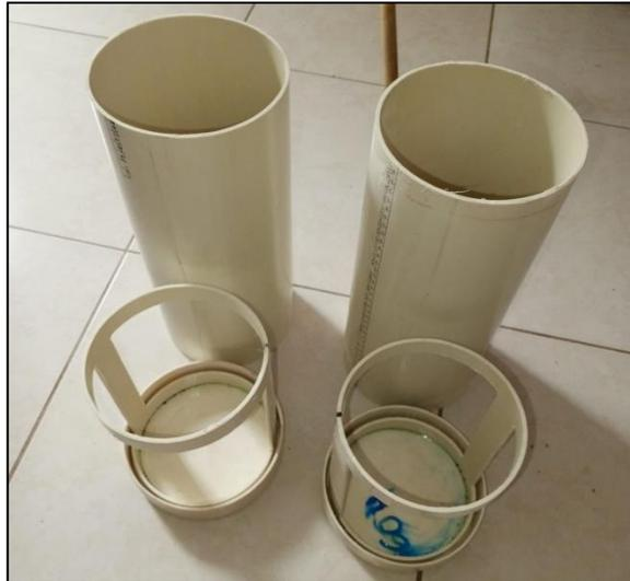
Figura 35. Tubos y soportes para encapsulado de los nodos
