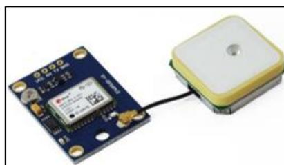
Figura 14. Módulo GPS Neo-6M [42]
