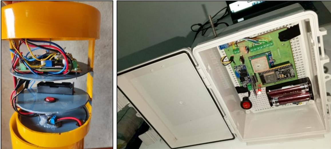
*Figura 63. Implementación de la parte electrónica en los nodos y gateway*
