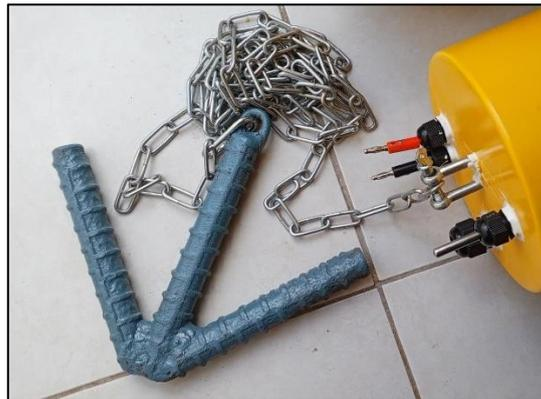
*Figura 40. Anclaje de los nodos*
