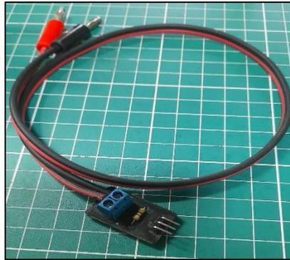
Figura 9. Sensor de conductividad para líquidos [34]
