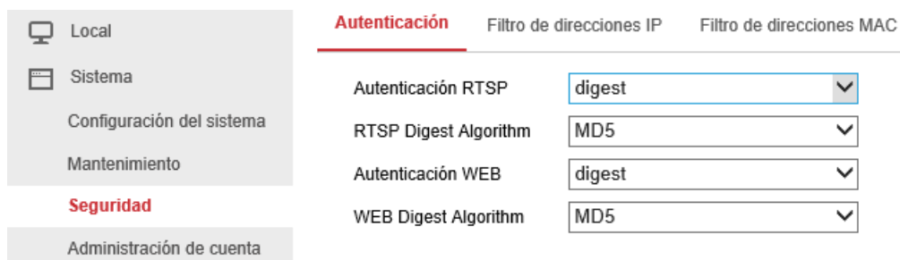
Figura 20. Configuración de autenticación de una cámara Hikvision.
