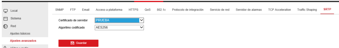
Figura 32. Configuración de protocolo y certificado SRTP.
