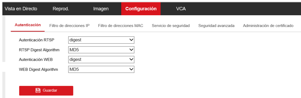
Figura 7. Algoritmos de hashing usados en las cámaras IP.
