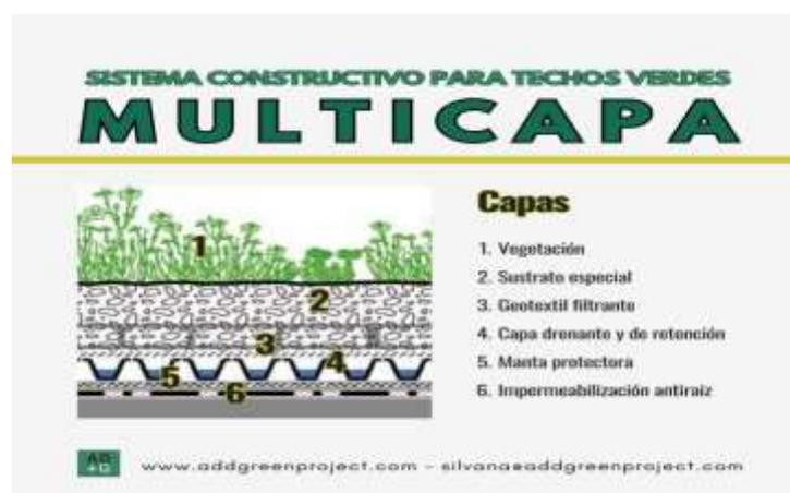
**Nota.** Tomado de (Amézquita, 2021). En la **Figura 3** se puede observar cada una de las capas del sistema constructivo de las cubiertas verdes.
