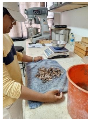
Figura 5 Eliminación de exceso de agua del agregado grueso
