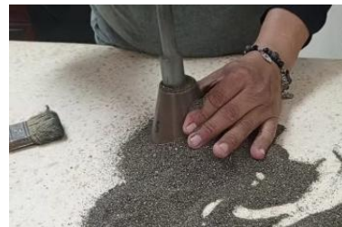
Figura 7 Ensayo de cono para determinar el estado de absorción del agregado fino
