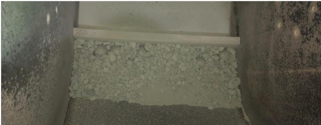
Material en el tambor de la máquina de abrasión Los Ángeles
