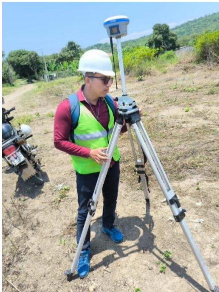
Figura 35: Calibración del equipo RTK
