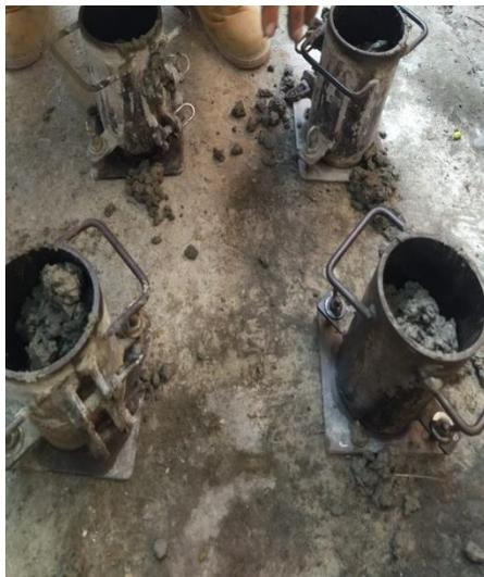
Moldes para la confección de cilindros de hormigón
