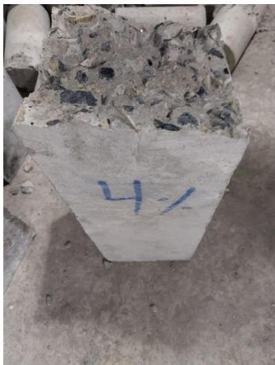
Rotura de viga a flexión con fibra de caña brava a 4%
