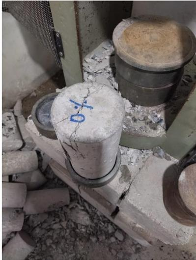
Probeta de hormigón rota a los 7 días
