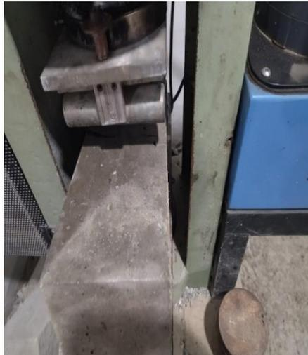
Colocación de viga de hormigón en acoples para la rotura a flexión
