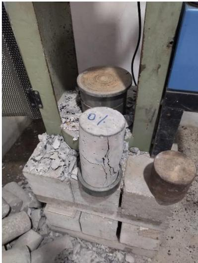
Probeta de hormigón rota a los 14 días
