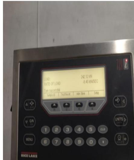
Panel con valores de carga máxima en kN de probeta de hormigón con 0% de fibra a los 14 días
