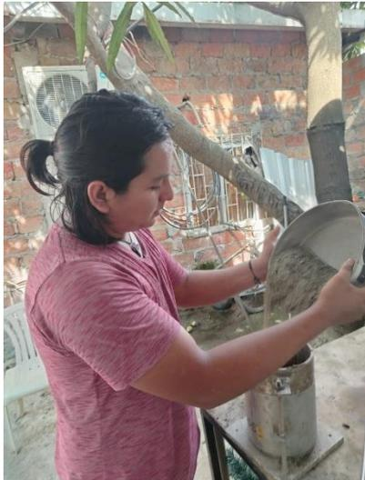
Ensayo de PUS del agregado fino, primera capa
