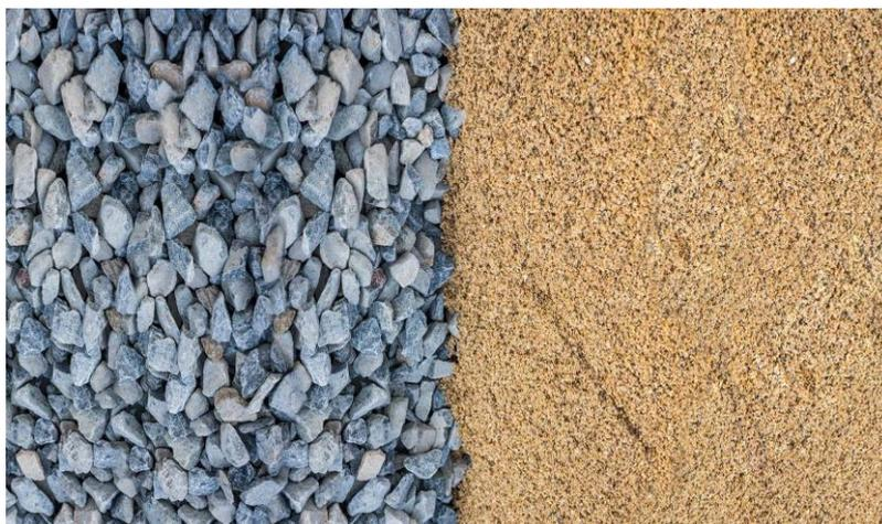
*Nota:* Áridos de serie fina y gruesa utilizados en la preparación de mezclas de concreto. Tomado de Instrucción Española del Hormigón Estructural.
