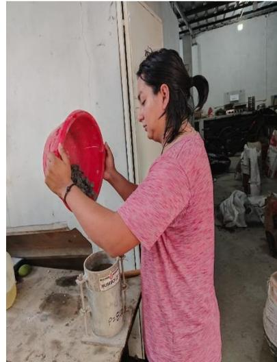
Ensayo de PUS del agregado grueso, primera capa
