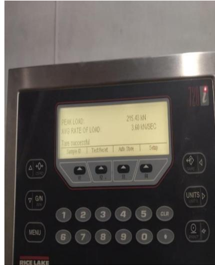
Panel con valores de carga máxima en kN de probeta de hormigón con 0% de fibra a los 7 días
