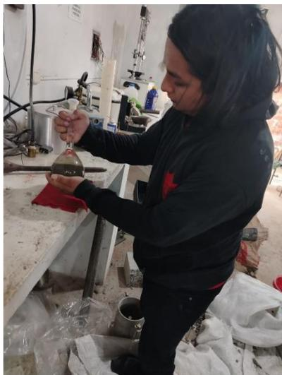
Movimiento reiterado con el picnómetro para obtener gravedades específicas y absorción
