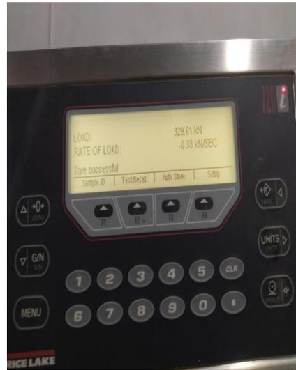
Panel con valores de carga máxima en kN de probeta de hormigón con 0% de fibra a los 28 días
