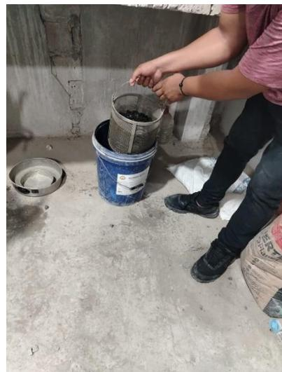
Retirada de canasta conteniendo el agregado grueso y pesado en agua
