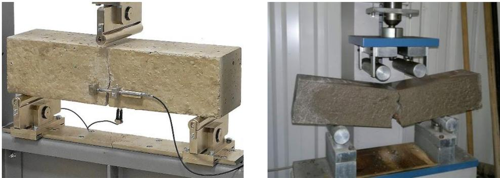
*Nota.* La figura muestra, en la parte izquierda, el esquema del equipo para ensayar a flexión una viga por tres puntos de apoyo, tomada de Controls Group (2024) mientras que en la parte derecha el mismo caso para el ensayo a cuatro puntos tomada de Eurolab Laboratory (2024).
