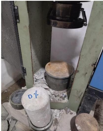
Probeta de hormigón rota a los 28 días
