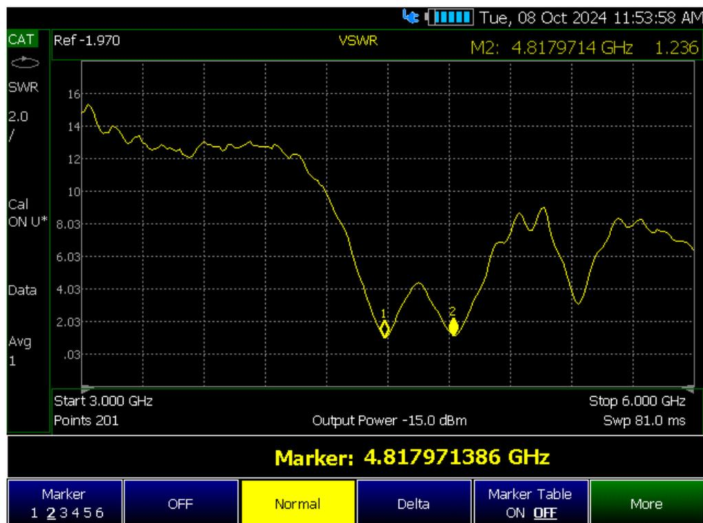
*Ilustración 49. Medición en el equipo del VSWR para la frecuencia de 4.8 GHz*
