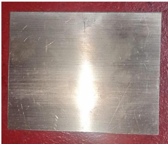
*Ilustración 38. Baquelita PCB con doble capa de cobre*
