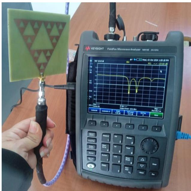
*Ilustración 45. Antena conectada al equipo mediante el cable coaxial*
