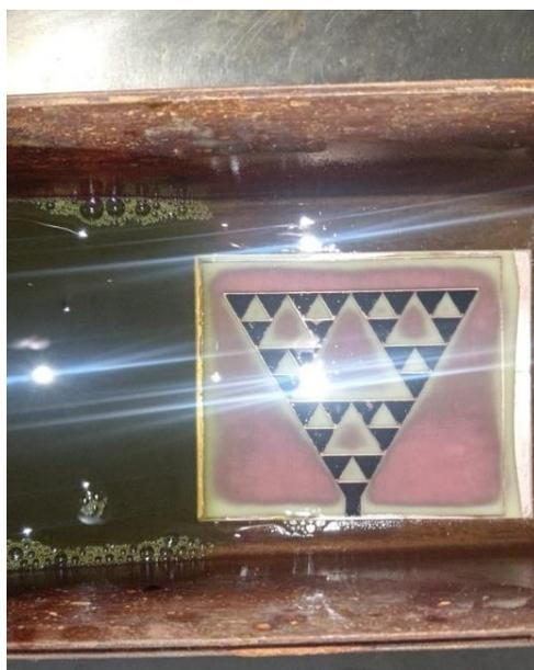
*Ilustración 41. Limpieza de la baquelita en ácido férrico*
