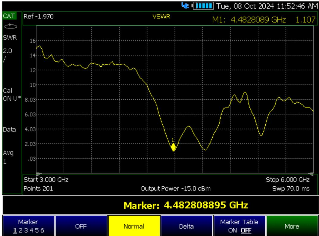
*Ilustración 48. Medición en el equipo del VSWR para la frecuencia de 4.5 GHz*
