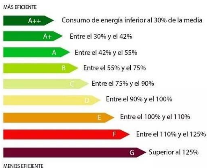
Ilustración 30 Eficiencia de viviendas según el desfase obtenido
