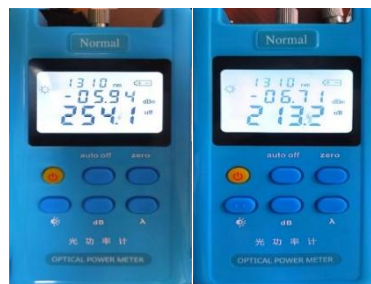
Figura 71. Potencia del primer enlace de fibra óptica.
