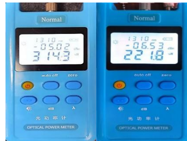
Figura 72. Potencia del segundo enlace de fibra óptica.
