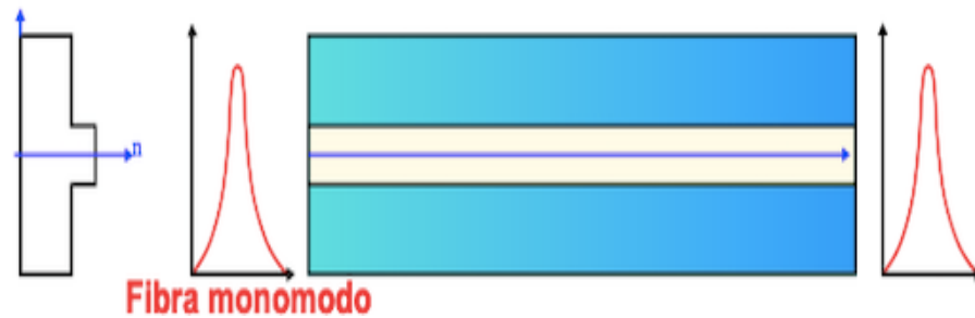
Figura 10. Luz propagada en la Fibra Monomodo.
