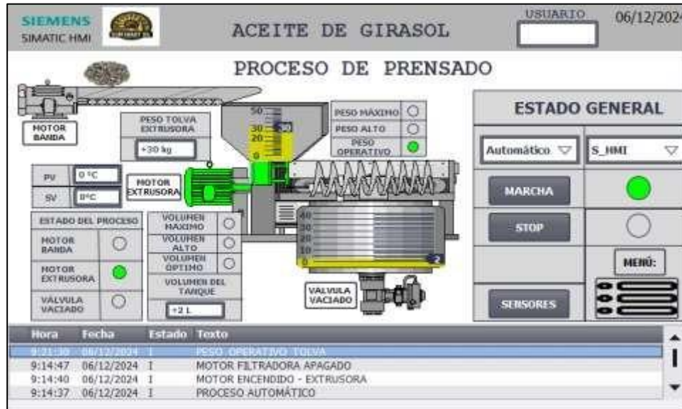
Figura 16. Llenado de la tolva de la extrusora. [Fuente: Autor]
