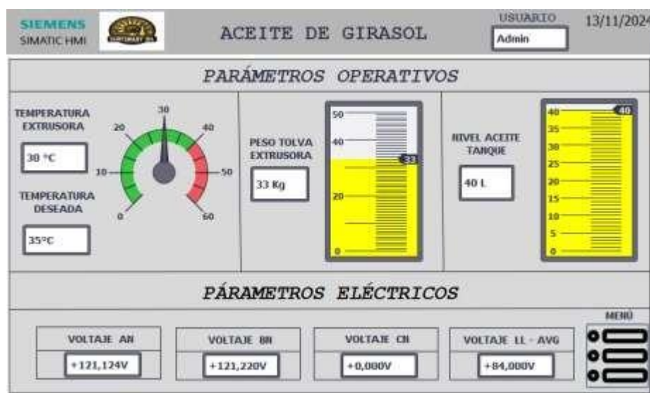
Figure 21. Parámetros operativos y eléctricos. [Fuente: Autor]
