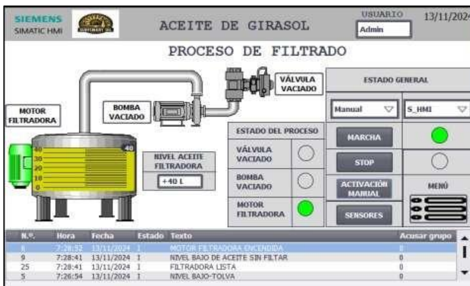
Figura 19. Filtrado centrífugo del aceite. [Fuente: Autor]
