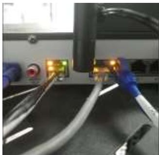
*Ilustración 349. Conexiones UTP de las cámaras en el NVR*
