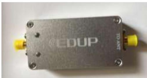
*Ilustración 85. Amplificador EP-AB049.*
