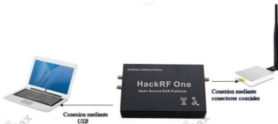
Ilustración 427. Esquema propuesto de conexiones física para el generador de ruido en 5Ghz.
