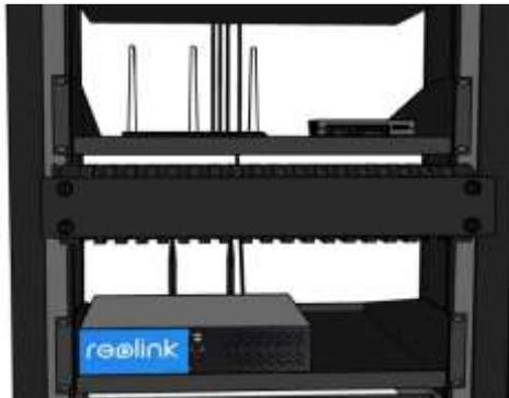
*Ilustración 118. Ubicación del router y NVR Reolink dentro del Rack.*
