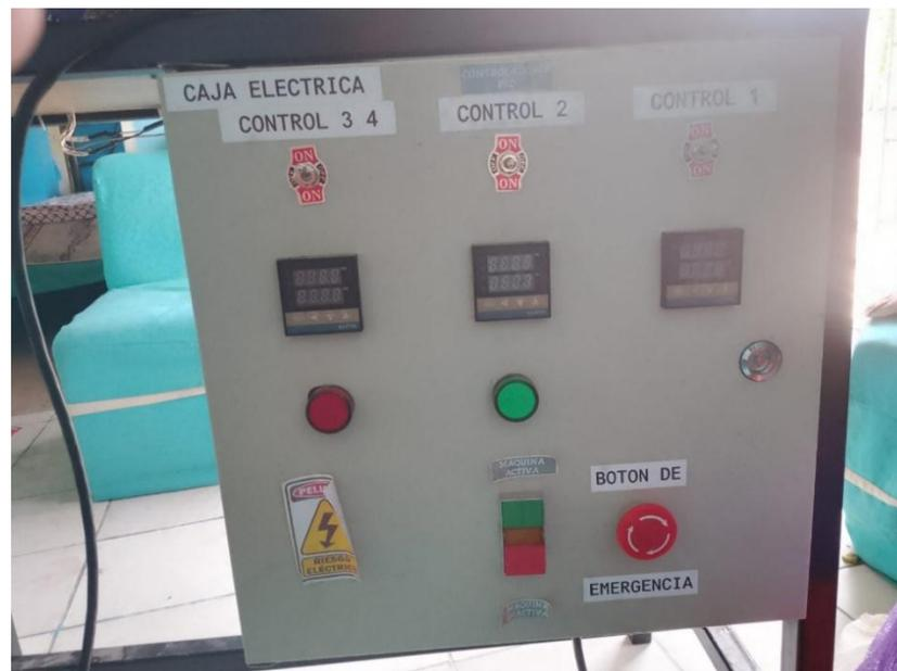
Nota. Sistema de apagado y controlador de temperaturas
