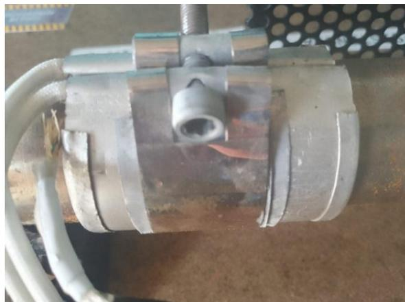
Nota. Resistencia para calentar el cilindro hasta 400°
