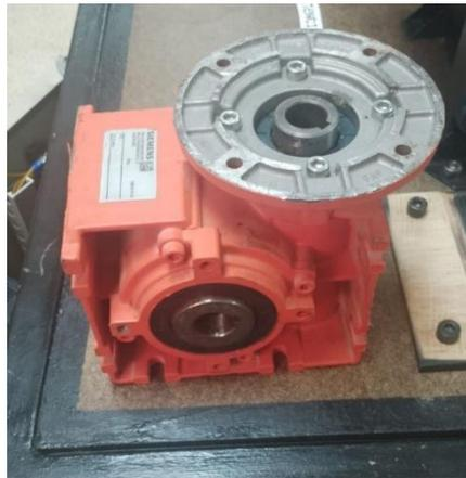
Nota. Se encarga de reducir la velocidad del tornillo de 15-50 rpm
