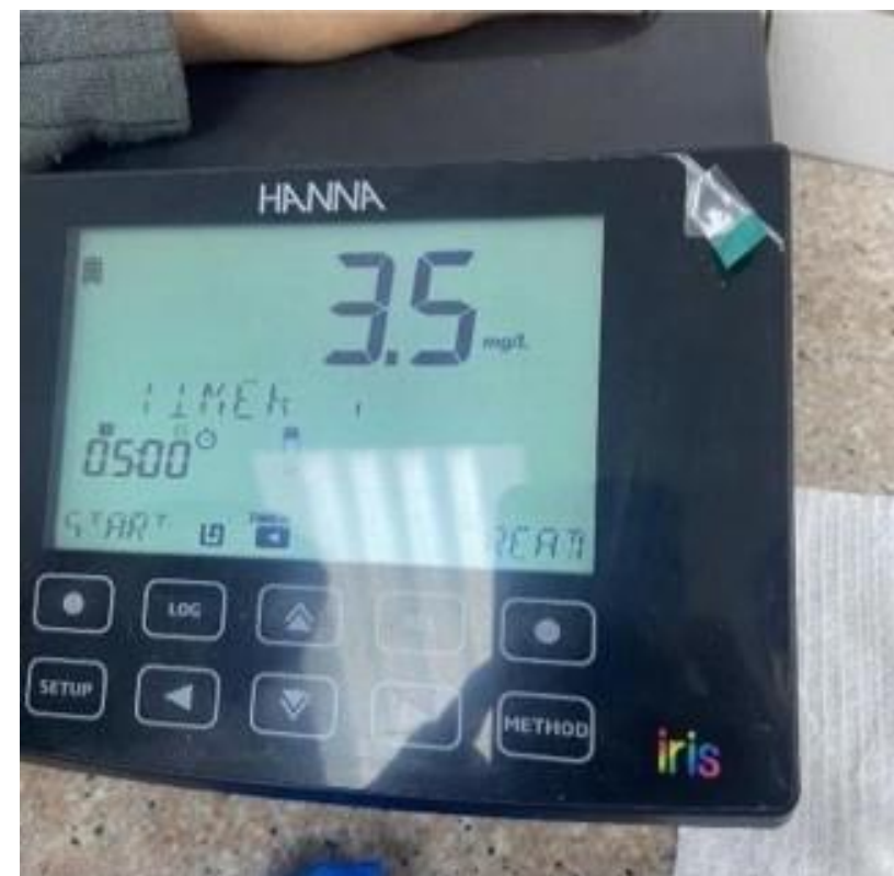
Anexo 7. Lectura de concentración de fosfatos con espectrofotómetro marca HANNA
