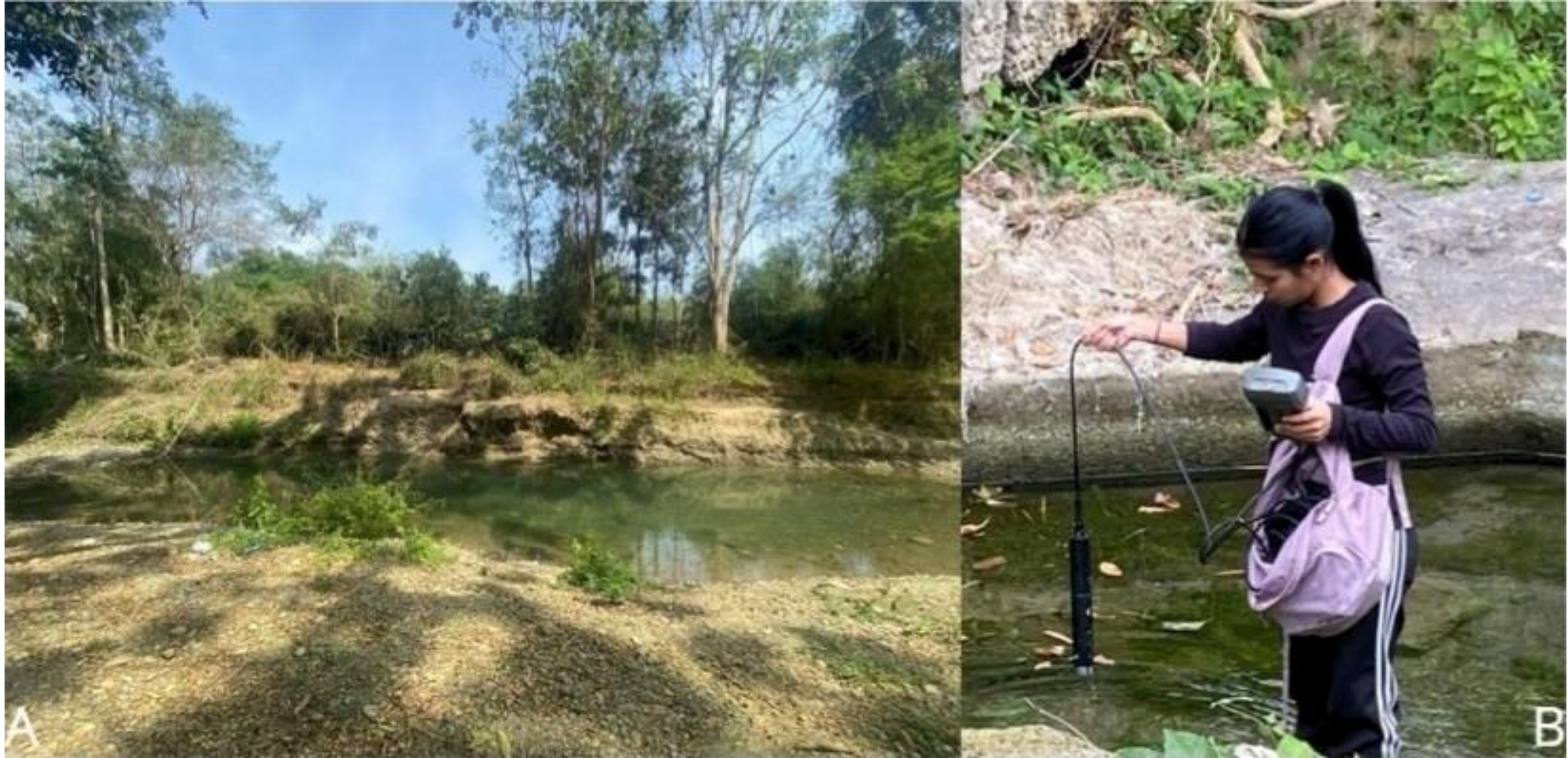
Imagen 4. A: Medición de estación para muestreo. B. Toma de datos con medidor multiparámetro HANNA.
