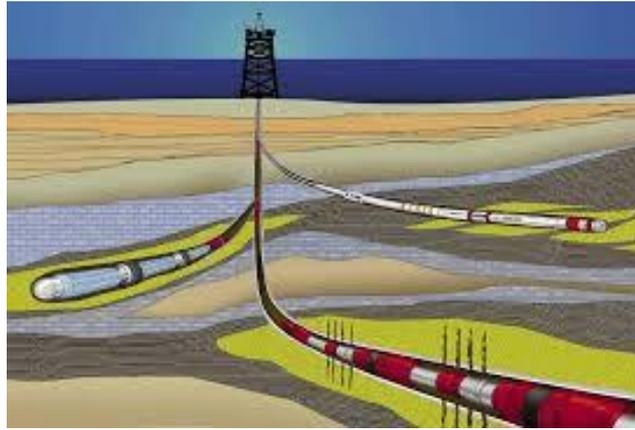
**Figura 4.** Perforación Multilateral.
