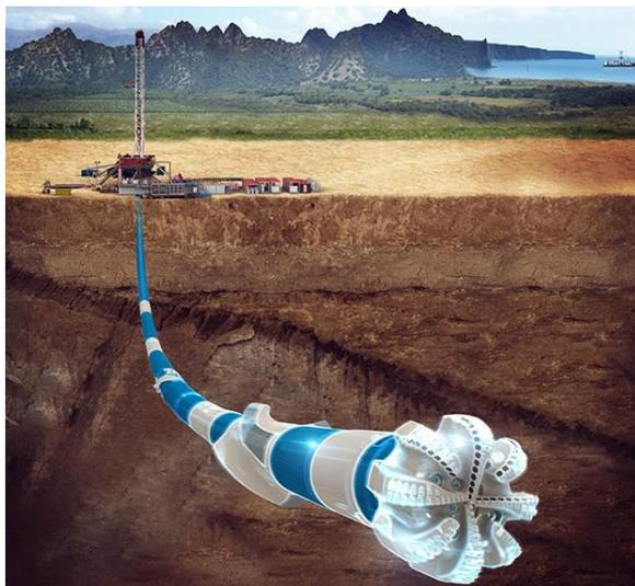
**Figura 2.** Perforación Horizontal.
