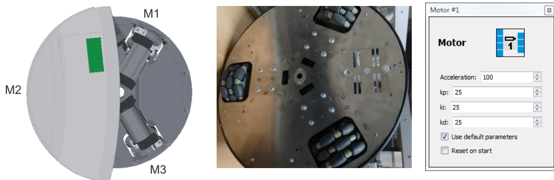
Figura 23 Ubicación de los motores en robotino y control por PID
