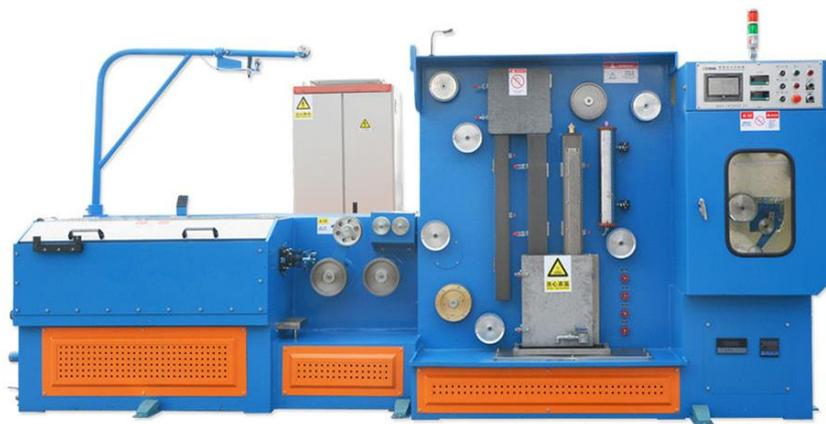
*Ilustración 2 Maquina de Trefilado*
